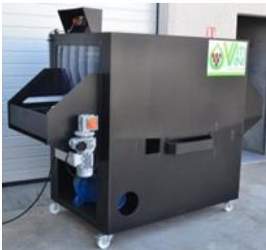
🍇 Laveuse fabriquée en PE adaptée pour tous types de caisses, structure montée sur roulettes pivotantes avec freins
