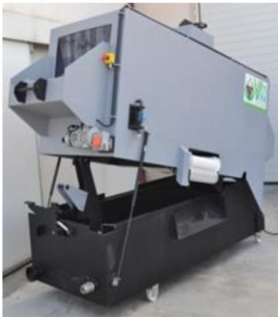
🍷 Laveuse fabriquée en PE adaptée pour tous types de caisses, structure montée sur roulettes pivotantes avec freins
